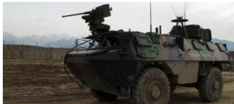
VAB TOP en Afghanistan: tourelle téléopérée de l'intérieur.
